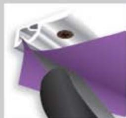
La toile est « clipsée » (insérée) dans la lèvre du profilé de tension à l'aide d'une spatule. Le système de pinces crantées du profilé permet la retenue de la toile.
